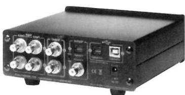
←アナログ音声入力を2系統装備し、プリアンプとしての特色を強めている。同軸、光のデジタル入力は192kHzまでの対応
